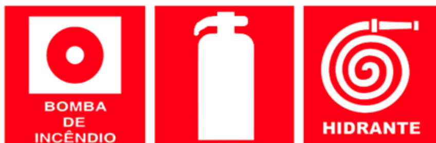
Figura 9: Exemplos de sinalização de equipamentos.
