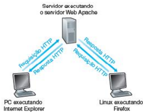
Figura 3 - Modelo de requisição e resposta do HTTP
