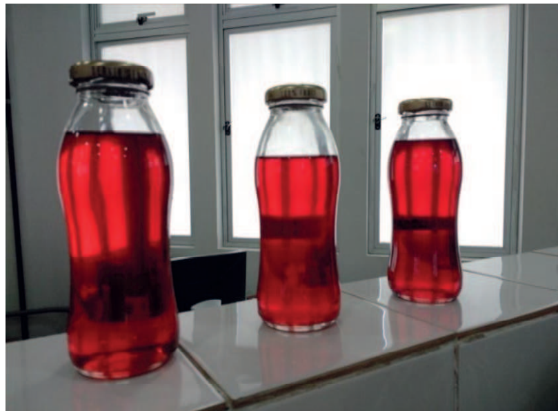
Figura 1: Análise de aspecto e cor em amostras de diesel S500.
