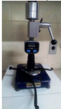
Figura 6: Teste de determinação da dureza Shore A
