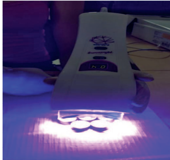
Figura 16- Aplicação do LED violeta \lambda 400\text{nm} \pm 10\text{nm} no grupo 6 e 7.
