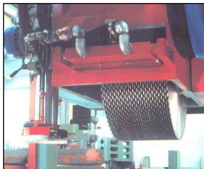
Figura 3 - Modelos de talha bloco multidiscos (a) e monodisco (b).
