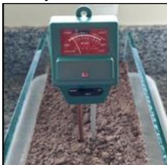
Figura 6 – Ensaio para determinação do tempo de saturação do solo.
