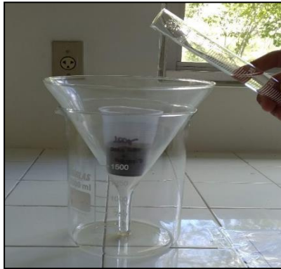
Figura 7 – Ensaio para determinação do tempo de saturação do solo.
