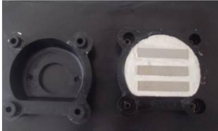
Figura 11- Posicionamento das matrizes metálicas sobre o gesso
