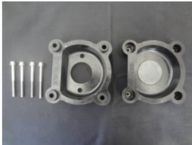
Figura 10- Mufla específica para polimerização em microondas
