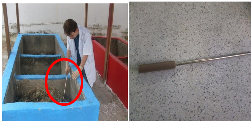
Figura 13- Fotos do instrumento de ferro para auxiliar a inserção do termômetro nas pilhas. Santa Rosa, Campina Grande-PB, Agosto de 2012.
