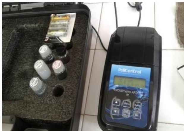
Figura 4: aparelho utilizado para medir a turbidez (turbidímetro)
