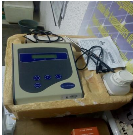
Figura 3: aparelho utilizado para medir a condutividade (condutivímetro)
