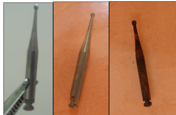
Figura 20 - Brocas de aço depois de imergidas no ácido peracético 2%, clorexidina 2% e glutaraldeído 2,5% após período de 28 dias
