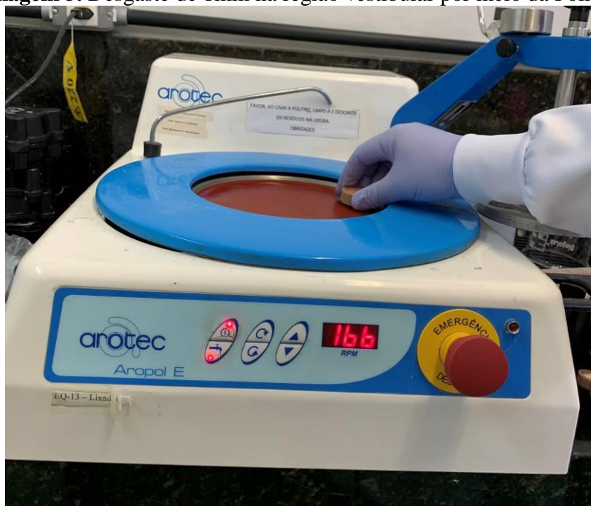
Imagem 5. Desgaste de 1mm na região vestibular por meio da Politriz.
