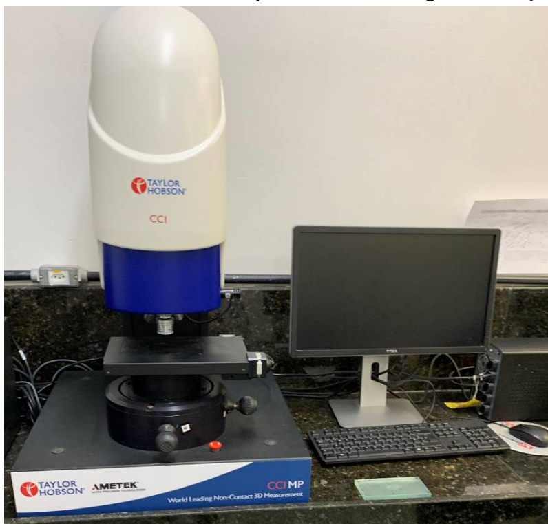
Imagem 6. Perfilômetro utilizado para a análise da rugosidade superficial.
