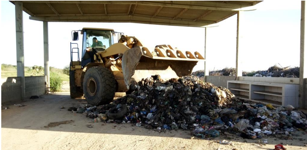
Figura 4 – Homogeneização dos resíduos.
