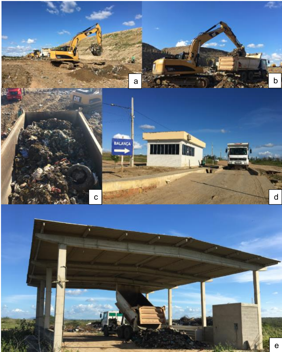
Figura 3 – (a) coleta da amostrados resíduos; (b) acondicionamento dos resíduos no caminhão caçamba; (c) resíduos acondicionados no caminhão caçamba; (d) pesagem dos resíduos; (e) disposição dos resíduos no galpão.
