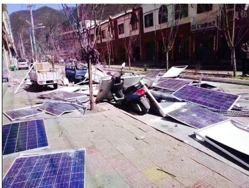
Figura 12 - Acidente provocado pela ação dos ventos em um gerador
