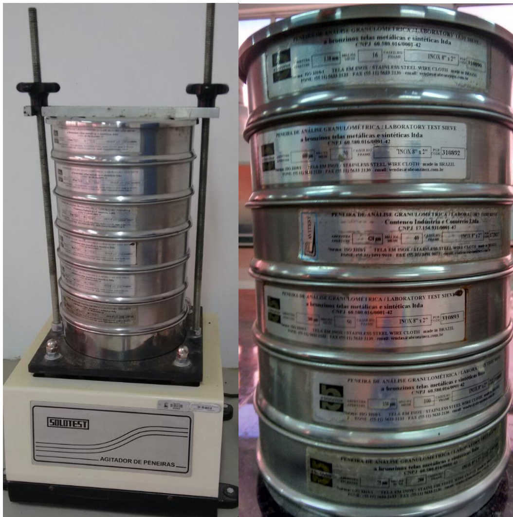
Figura 17: Ensaio de peneiramento
