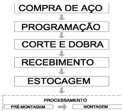
Figura 3 - Fluxograma de produção das armaduras para o aço entregue já cortado e dobrado.
