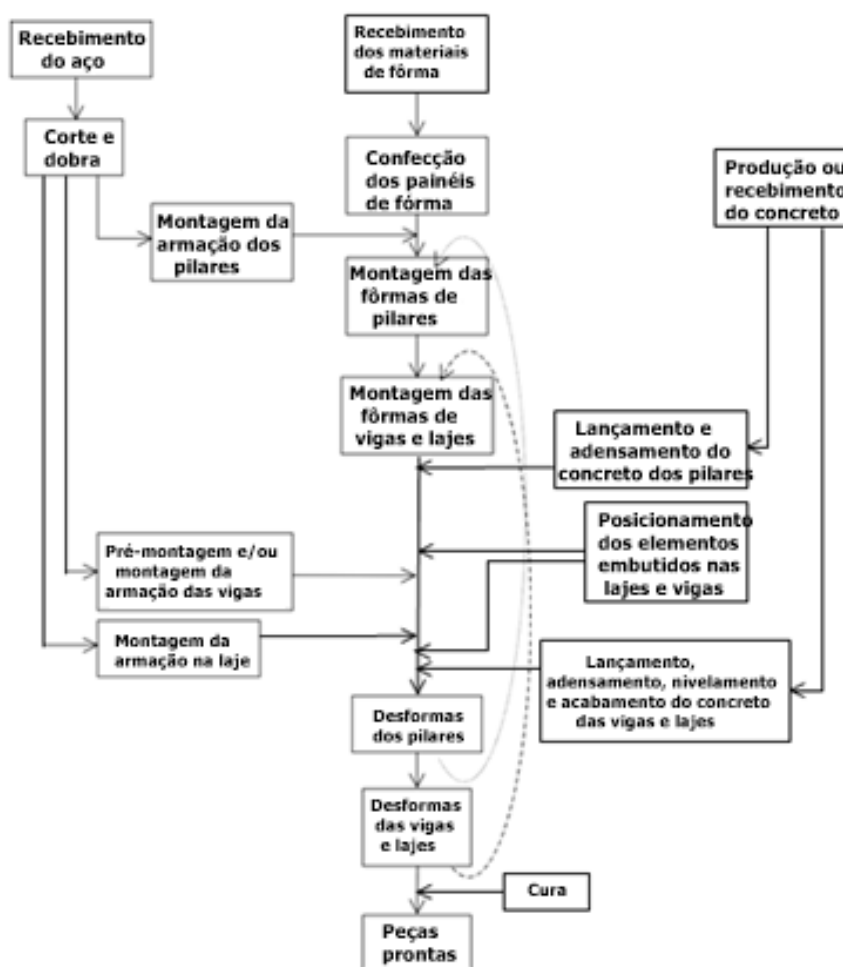
Figura 1 – Esquema genérico da produção de elementos em concreto armado.
