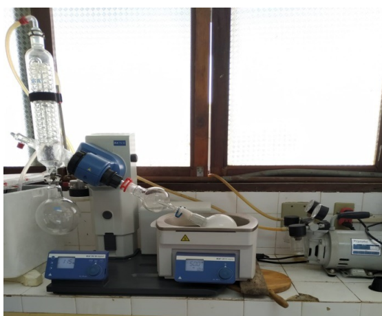
Figura 7: Processo de rotaevaporação da amostra, obtendo somente as nanopartículas de TiO_2 .
