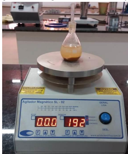
Figura 16 - Aquecimento do picnômetro com o conjunto solo-água.
