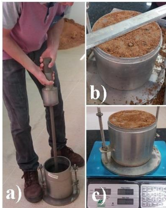
Figura 19 - Etapas do ensaio de compactação. a) Compactação do corpo de prova na energia intermediária; b) Rasamento do excesso de material; c) Pesagem do conjunto (molde + solo compactado).
