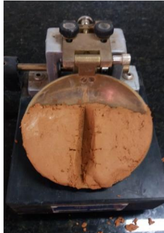
Figura 14 - Canelura na amostra de solo na concha do aparelho de Casagrande.
