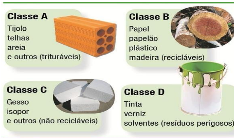
Figura 6 - Classificação dos resíduos da construção civil.
