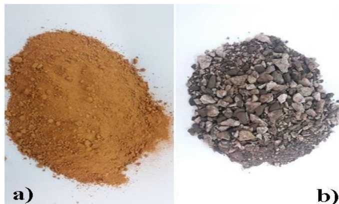
Figura 10 - Materiais utilizados na pesquisa. a) Amostra de solo natural; b) Amostra de resíduo da usinagem de misturas asfálticas.
