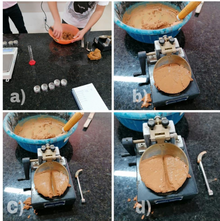
Figura 07: Ensaio de Limite de Liquidez. a) Preparação da amostra; b) Concha preenchida com a amostra; c) Abertura da ranhura de 1 cm; d) Fechamento da ranhura após os golpes.
