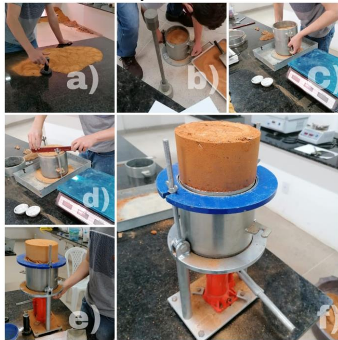
Figura 13: Ensaio de compactação. a) Destorroamento da amostra; b) Corpo de prova compactado; c) Remoção do cilindro complementar; d) Remoção do excesso de solo; e) Extração do corpo de prova; f) Detalhe do corpo de prova extraído.
