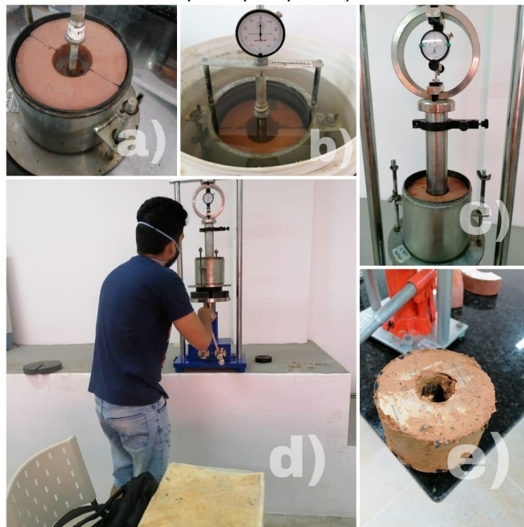
Figura 14: Ensaio de CBR. a) Adição das sobrecargas sobre o corpo de prova compactado; b) Corpo de prova imerso em água; c) Instalação do corpo de prova na prensa; d) Início da penetração do corpo de prova; e) Corpo de prova após a penetração.
