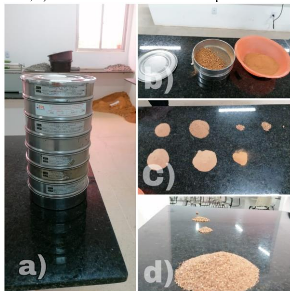
Figura 09: Ensaio de Peneiramento. a) Série de peneiras; b) Peneiramento manual; c) Material retido em cada peneira; d) Detalhe do material retido nas peneiras maiores.
