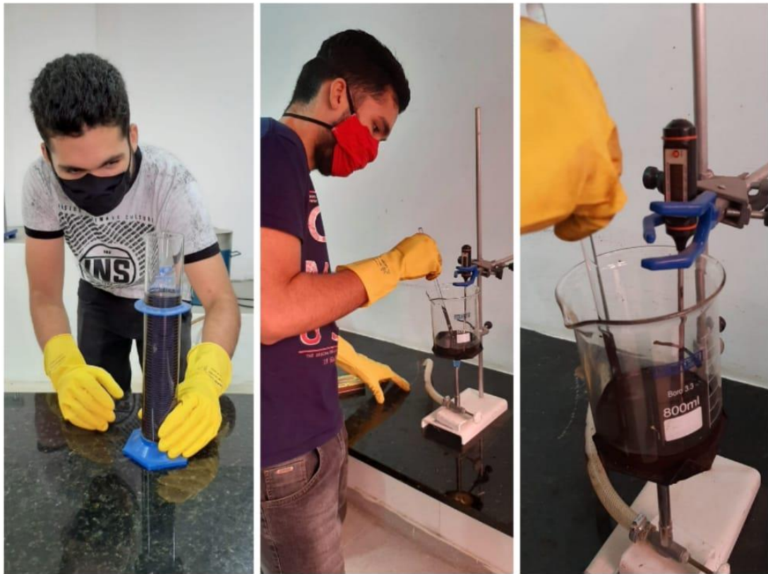
Figura 12: Ensaio de sedimentação. a) Proveta contendo a emulsão para ser deixada em repouso por 5 dias; b) Ensaio de resíduo seco da amostra retirada do topo; c) Ensaio de resíduo seco da amostra retirada do fundo.
