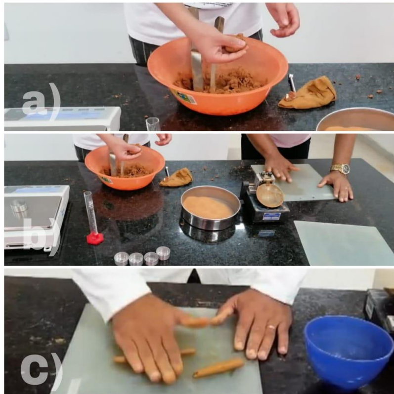
Figura 08: Ensaio de Limite de Plasticidade. a) Preparação da amostra; b) Modelagem e moldagem a amostra; c) Detalhe do rolamento da amostra no vidro esmerilhada.
