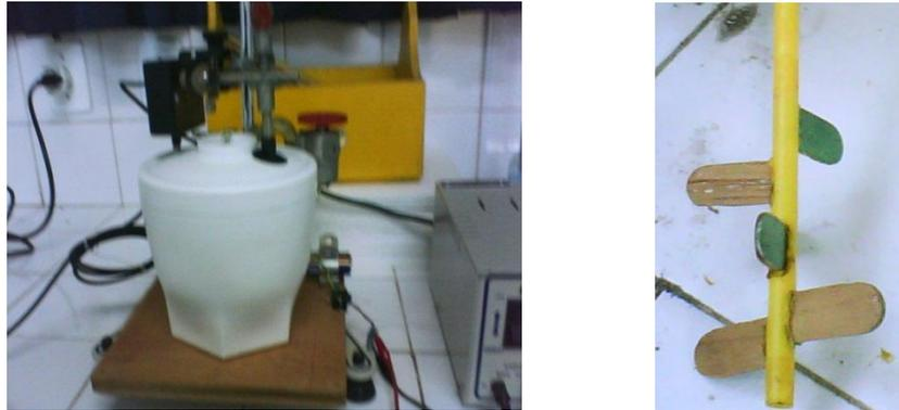
Figura 2 – (a) perspectiva da montagem do experimento (b) eixo de atrito com 5 pás.
