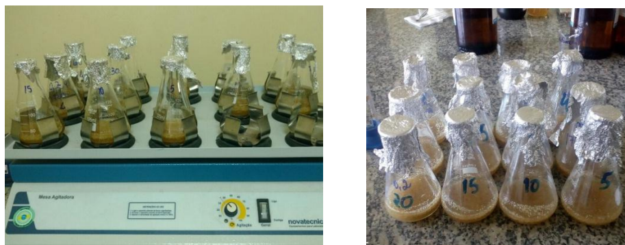
Figura 7 - Mesa agitadora com dispersão água/gasolina/biomassa palha do milho e frascos retirados após o tempo pré-determinado.
