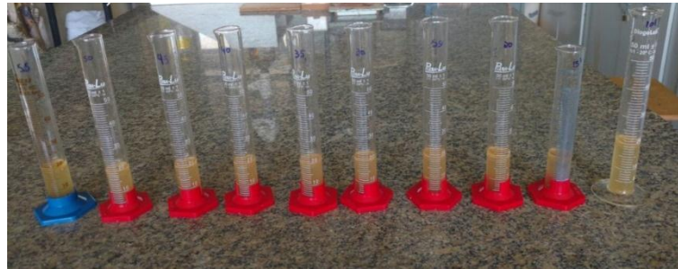
Figura 8 - Provetas com dispersão obtida após à adsorção, para quantificar a gasolina adsorvida por análise volumétrica.
