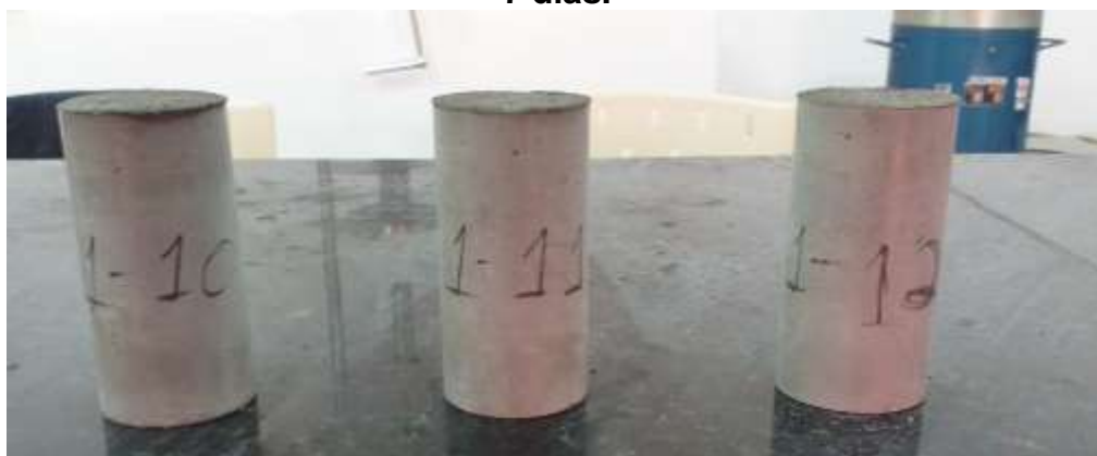
Imagem 39- Corpos de prova do traço T1 da argamassa analisada à tração aos 7 dias.
