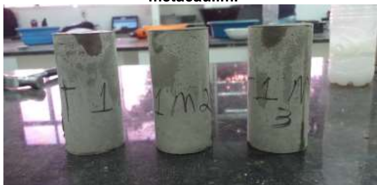
Imagem 22- Corpo de prova T1m realizada com argamassa à base de metacaulim.
