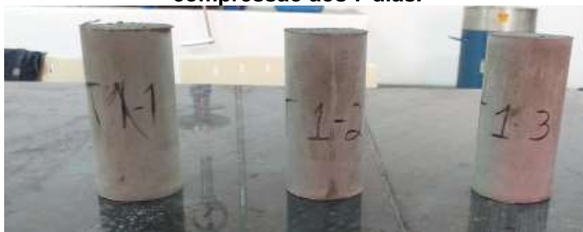
Imagem 29- Corpos de prova do traço T1 da argamassa analisada à compressão aos 7 dias.
