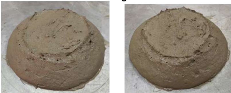
Imagem 8 - Índice de consistência argamassa com metacaulim T1m.
