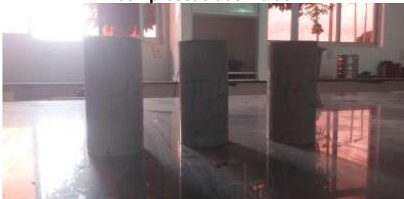
Imagem 32- Corpos de prova do traço T4 da argamassa analisada à compressão aos 7 dias.
