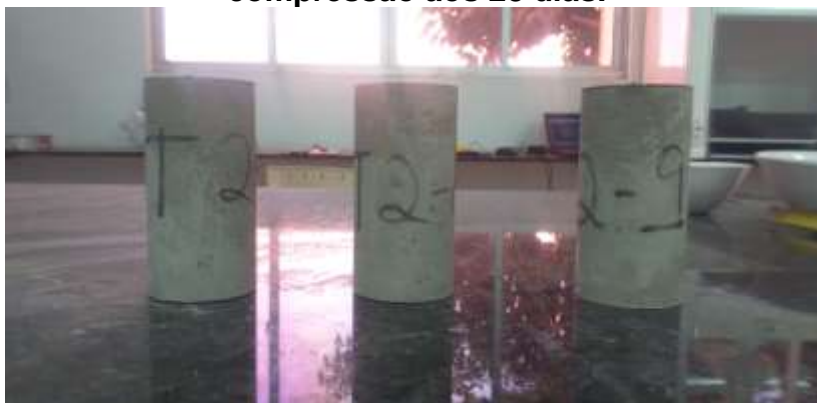
Imagem 37- Corpos de prova do traço T2 da argamassa analisada à compressão aos 28 dias.
