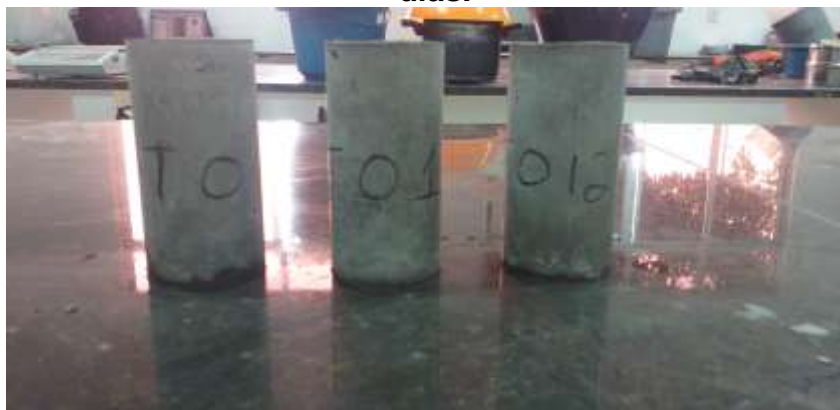
Imagem 38- Corpos de prova T0 da argamassa analisada sobre tração aos 7 dias.
