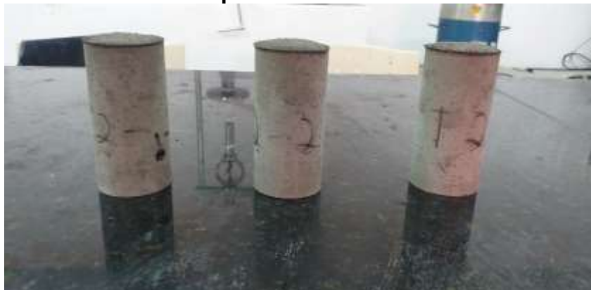
Imagem 30- Corpos de prova do traço T2 da argamassa analisada à compressão aos 7 dias.
