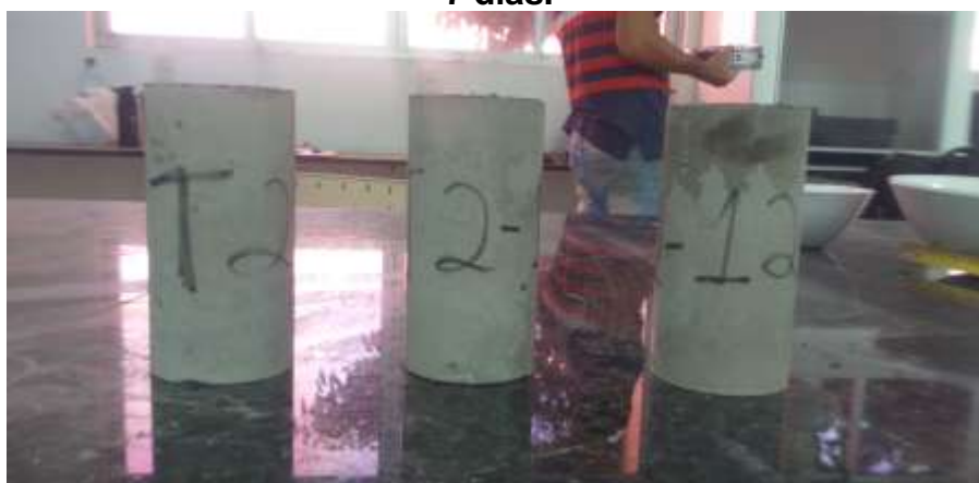
Imagem 40- Corpos de prova do traço T2 da argamassa analisada à tração aos 7 dias.
