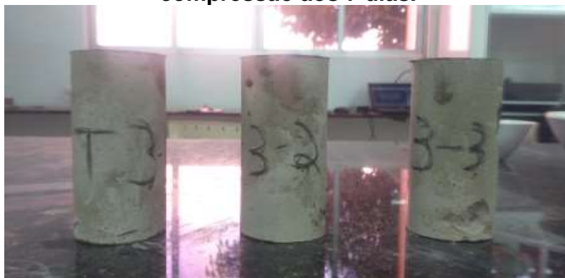
Imagem 31- Corpos de prova do traço T3 da argamassa analisada à compressão aos 7 dias.
