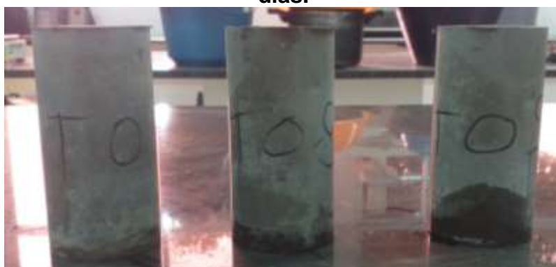
Imagem 35- Corpos de prova T0 da argamassa analisa à compressão aos 28 dias.
