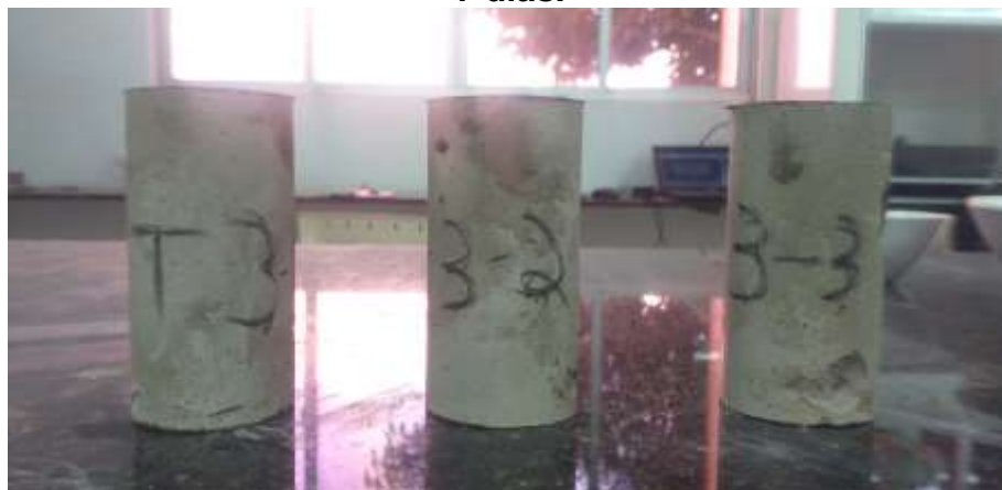
Imagem 41 - Corpos de prova do traço T3 da argamassa analisada à tração aos 7 dias.
