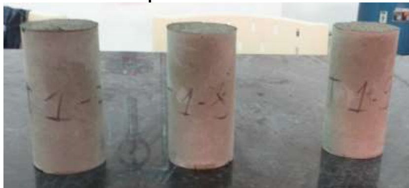
Imagem 36- Corpos de prova do traço T1 da argamassa analisada à compressão aos 28 dias.
