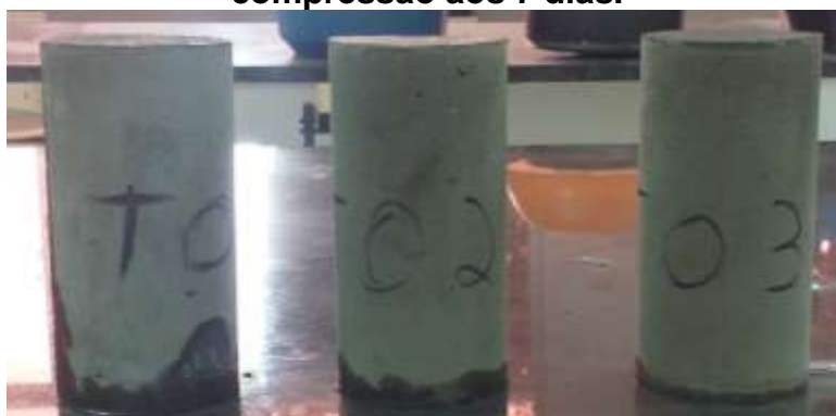
Imagem 28- Corpos de prova do traço T0 da argamassa analisada à compressão aos 7 dias.
