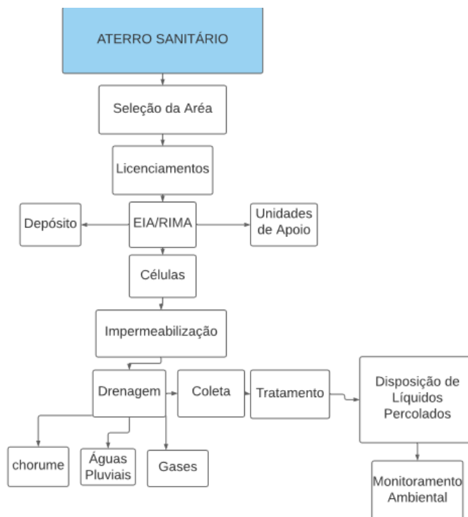
Figura 1 – Etapas de implantação de um aterro sanitário
