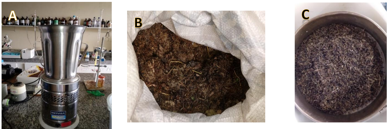
Figura 04 – (A) Liquidificador Industrial, (B) Algas “Arribadas” em sua forma natural e (C) em sua forma seca e peneirada
