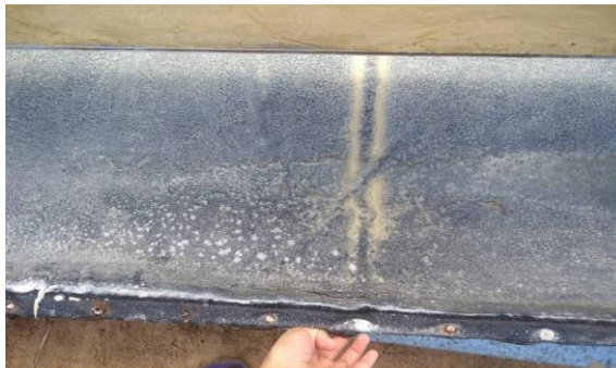
Figura 3. Rejeito salino que se forma após a evaporação na base do destilador.
