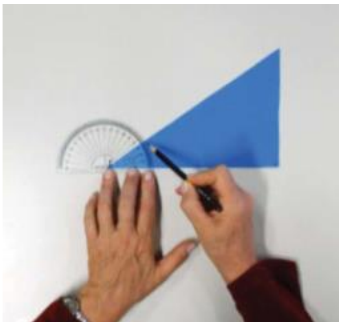
Figura 19: Marcação dos ângulos com o transferidor
