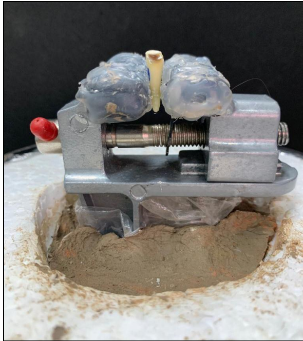
Figura 6: Suporte confeccionado para evitar contato com as mãos do operador e possíveis trocas de calor.
