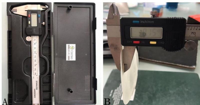
Figura 13 – (A) Paquímetro digital; (B) medição da espessura.
