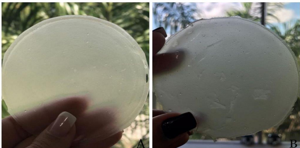
Figura 18 – (A) Filme de amido com 10% e (B) 15% de PVP.
