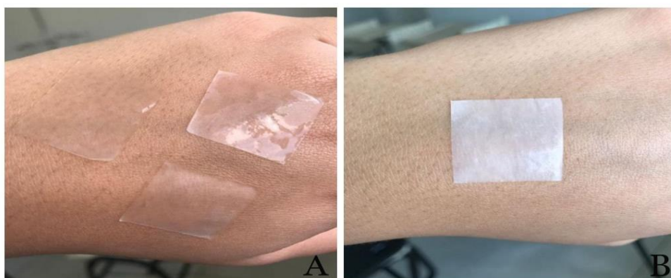
Figura 26 – (A) Filme de amido sem PVP e (B) com PVP.
