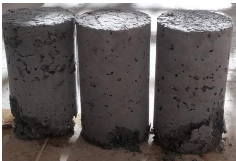
Figura 10 – Corpos de provas com substituição parcial do agregado miúdo por polietileno em um teor de 30%.
