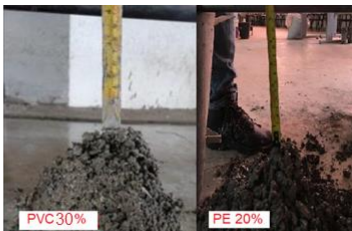
Figura 9 – Ensaio de Abatimento do concreto.
