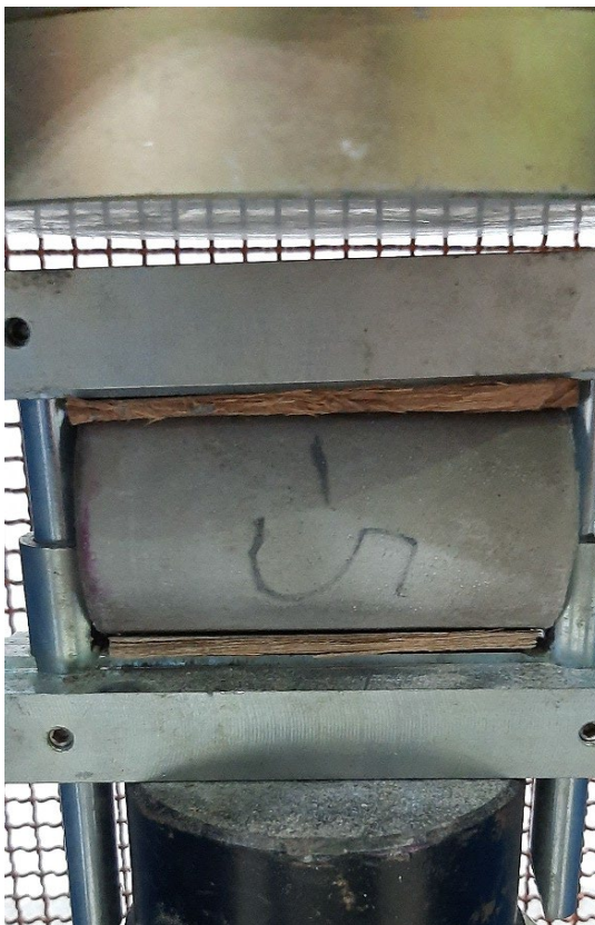
Figura 03 – Tiras de madeiras utilizadas no ensaio de tração por compressão diametral
