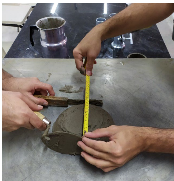
Figura 04 – Aferição do espalhamento da argamassa durante ensaio de IC
