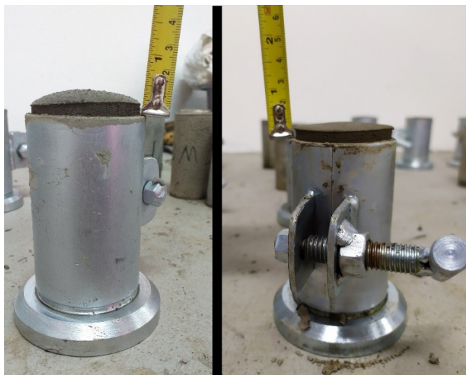
Figura 09 – Expansão da argamassa contendo sílica ativa
