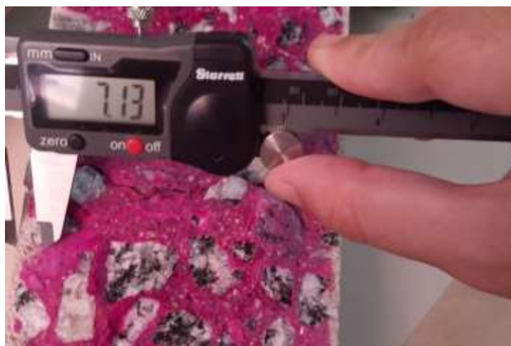
Figura 17 - Medição da Profundidade de Carbonatação para os corpos de prova
