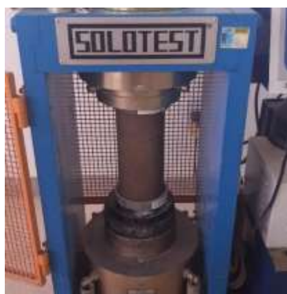
Figura 9 - (a) Corpo de prova posicionado na prensa para ser comprimido, (b) Corpo de prova rompido após o ensaio de compressão
