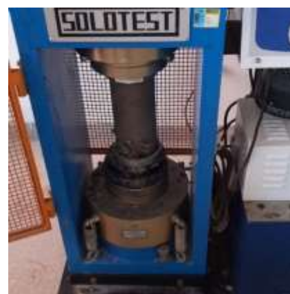
Figura 9 - (a) Corpo de prova posicionado na prensa para ser comprimido, (b) Corpo de prova rompido após o ensaio de compressão
