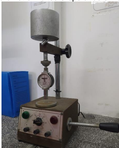
Figura 15 - Durômetro Wulstest® operando em escala Shore D
