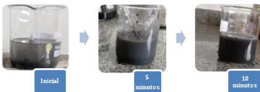
Figura 18 - Registros do teste de solubilidade com acetona/etanol (1:1) (Incrustação recente)
