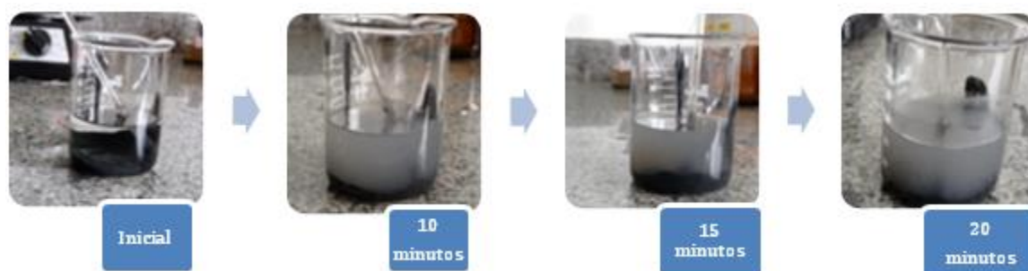
Figura 19 - Registros do teste de solubilidade com etanol (1:1) (Incrustação recente)
