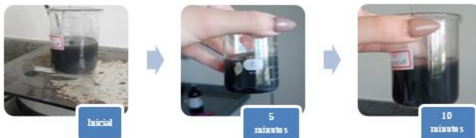
Figura 16 – Registros do teste de solubilidade com acetona pura (Incrustação recente)
