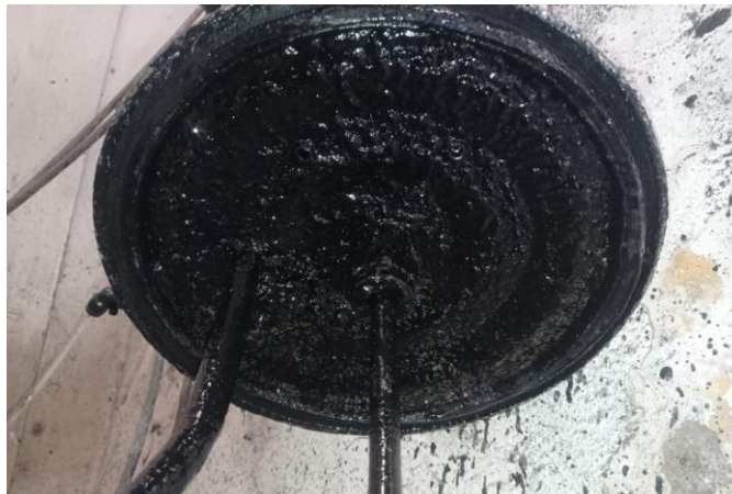
Figura 14 – Incrustações presentes nas painelas de pistolagem do gel coat.
