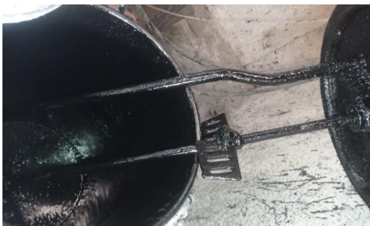
Figura 13 – Incrustações presentes nas panelas de pistolagem do gel coat.
