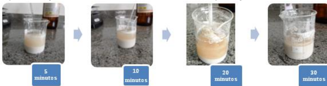
Figura 20 - Registros do teste de solubilidade com acetona (Incrustação antiga)
