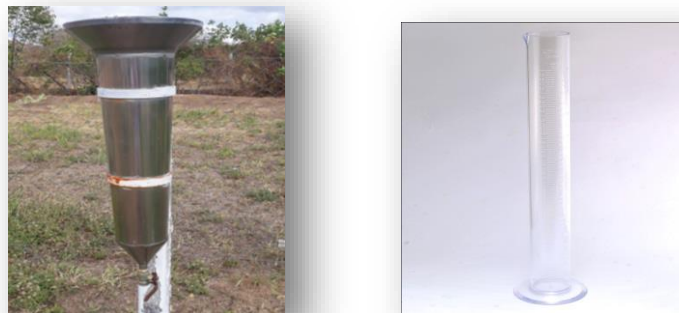
Figura 2. Pluviômetro Ville de Paris 125 mm milimetrado, instalado na Estação de meteorológica da Escola Agrotécnica do Cajueiro/UEPB/Campus IV, 2020 e a Proveta pluviométrica.
