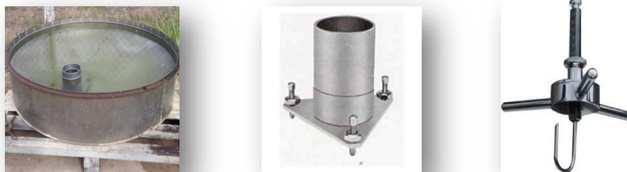
Figura 1. Tanque classe A da estação meteorológica da Escola Agrotécnica do Cajueiro/UEPB/Campus IV, 2020, o Poço tranquilizador de metal e o Micrômetro de gancho.
