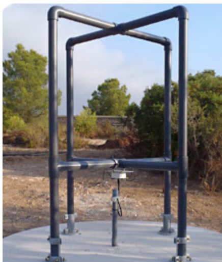
Figura 5.2: Antena receptora. Fonte: Lowell Digisonde International, LLC
