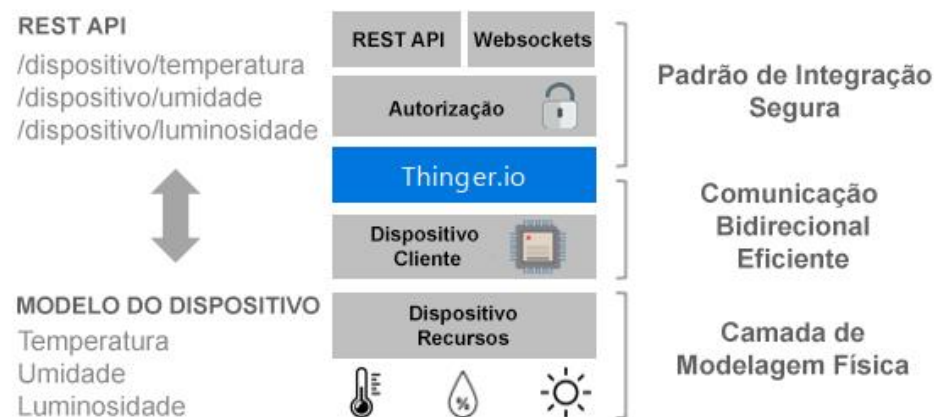
Figura 5 - Conversão de modelo de dispositivo para API REST
