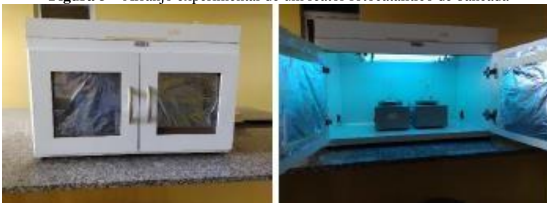
Figura 5 – Arranjo experimental de um reator fotocatalítico de bancada
