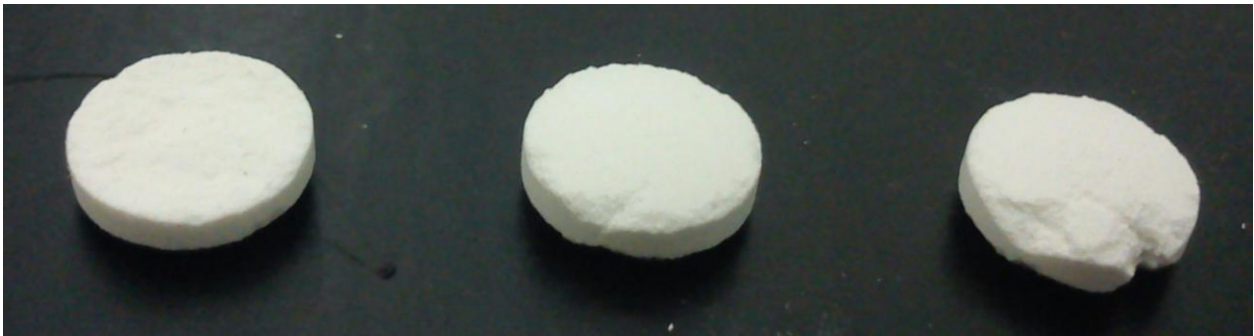
Figura 05: Comprimidos da formulação F2 rachados e lascados após o teste de friabilidade.
