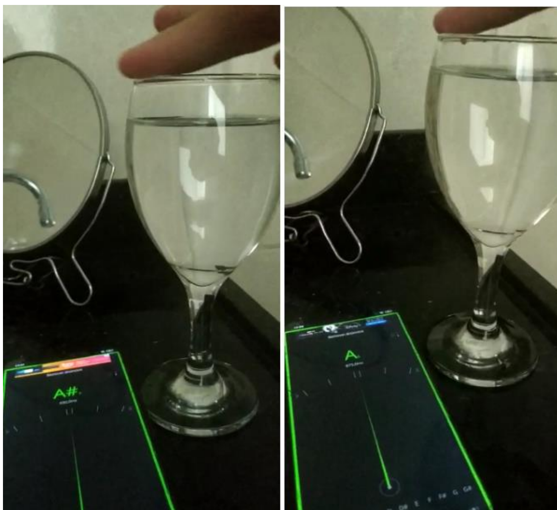
Figura 2: Taças emitindo frequências diferentes por conta do nível de água.
