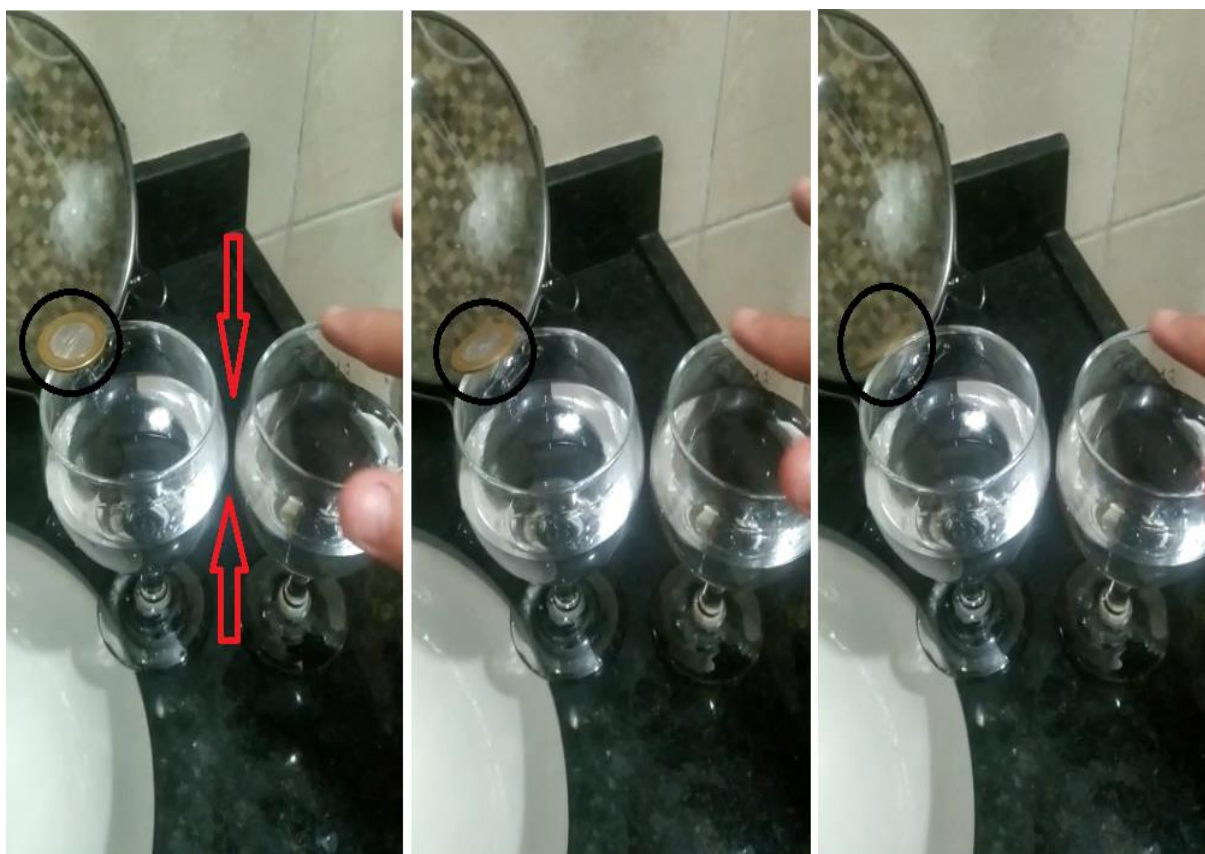
Figura 3: Taças próximas demonstrando efeito de ressonância.
