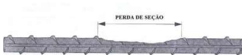
Figura 7 – Perda de seção na barra devido à corrosão eletroquímica
