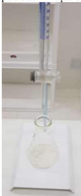
Figura 17 - Equipamento para determinação da alcalinidade das amostras
