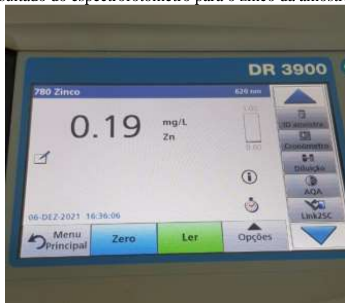
Figura 19 - Resultado do espectrofotômetro para o zinco da amostra de água filtrada
