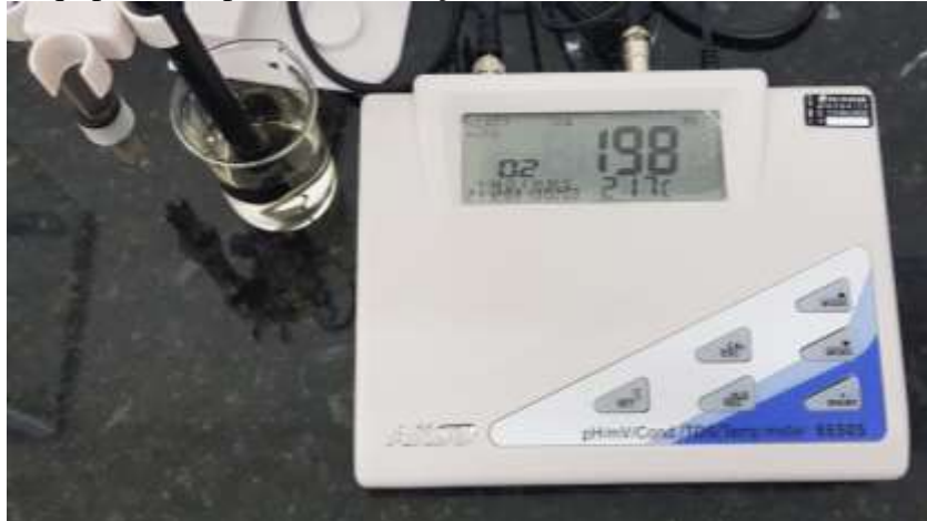
Figura 16 - Equipamento para determinação dos sólidos dissolvidos totais das amostras
