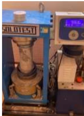
Figura 26 - Ensaio de resistência à compressão
