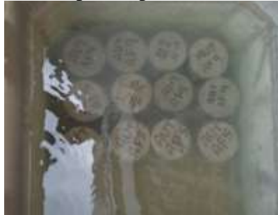
Figura 25 - Corpos de prova em cura submersa
