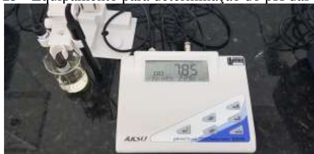
Figura 15 - Equipamento para determinação do pH das amostras
