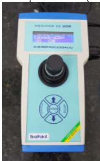
Figura 14 - Equipamento para determinação da cor das amostras
