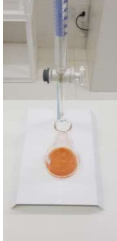
Figura 18 - Equipamento para determinação do cloreto das amostras
