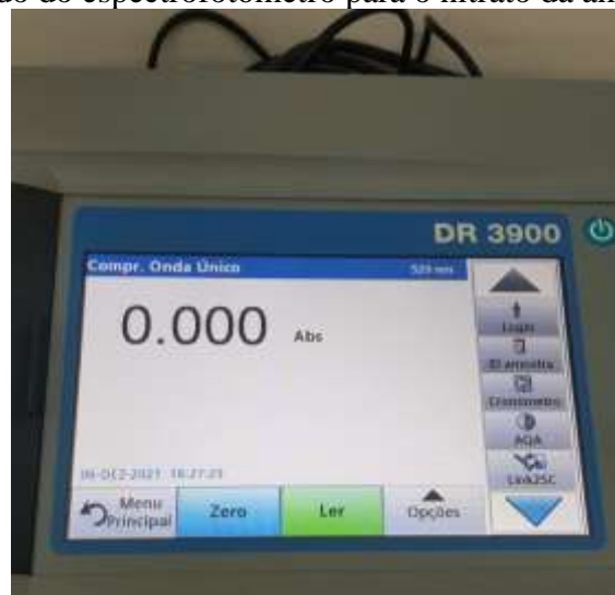
Figura 21 - Resultado do espectrofotômetro para o nitrato da amostra de água filtrada
