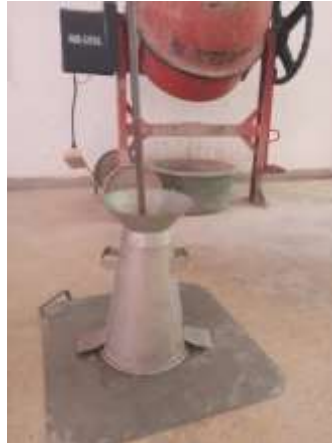
Figura 22 - Ensaio do abatimento do tronco de cone
