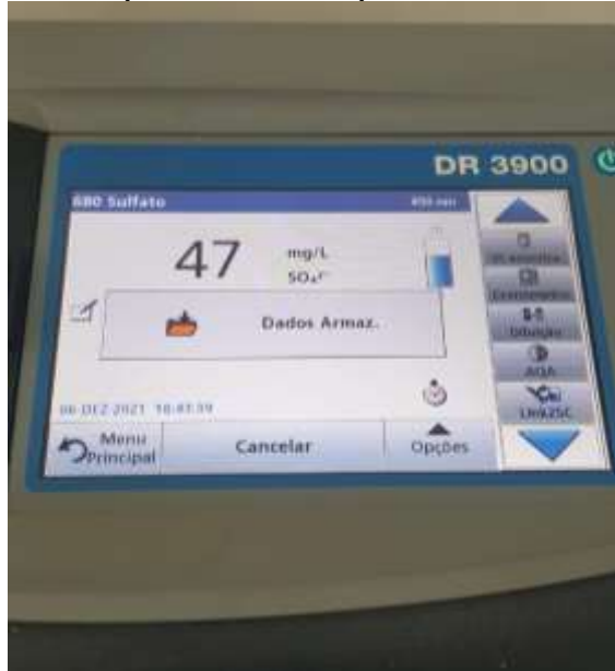
Figura 20 - Resultado do espectrofotômetro para o sulfato da amostra de água bruta
