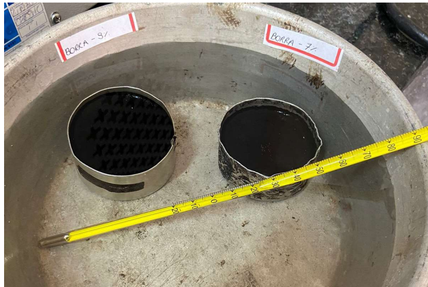
Figura 4 - Amostras de ligante asfáltico utilizadas no ensaio de penetração
