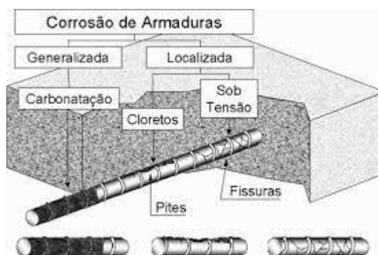
Figura 9 – Tipos de corrosão em armaduras
