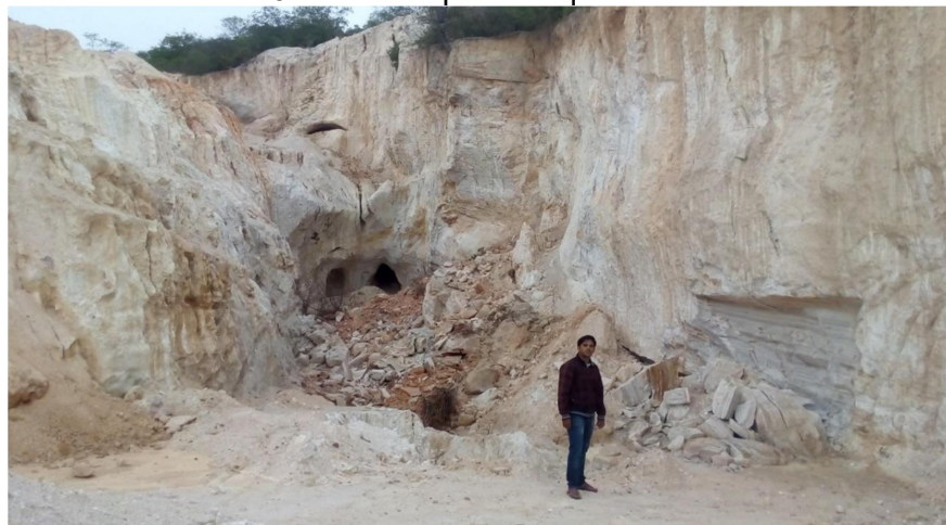
Figura 3: Galeria a céu aberto para exploração do caulim com o uso de máquinas, localizada no sítio Jacú município de Equador - RN.
