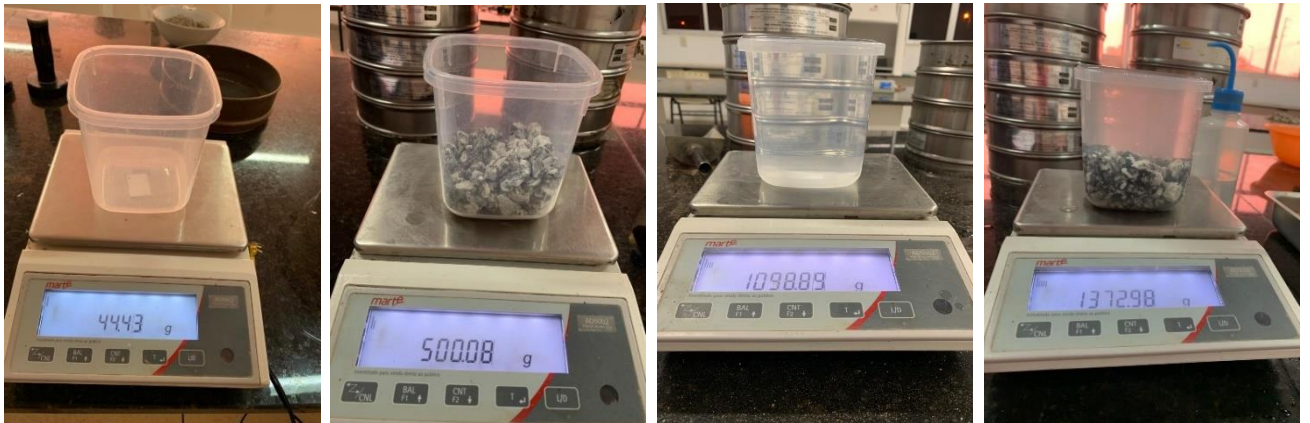
Figura 11 - Ensaio massa específica para brita
