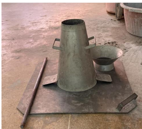
Figura 3 - Molde do Slump Test
