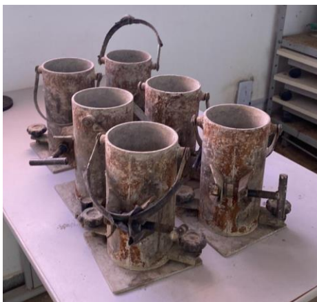
Figura 8 - Molde com dimensões 10cm x 20cm
