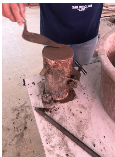
Figura 16 - Confeção nos moldes
