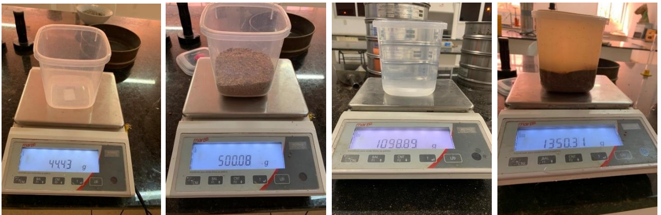
Figura 10 - Ensaio massa específica para areia
