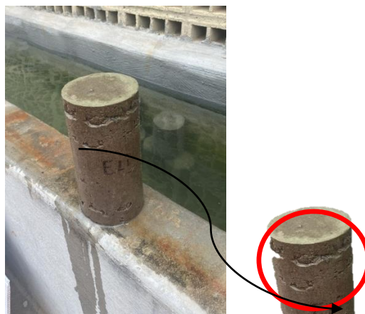
Figura 22 - Corpo de prova com 25% de RCV apresentando porosidade
