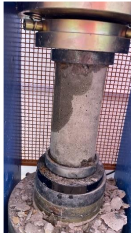
Figura 17 - Corpo de prova rompido na prensa hidráulica
