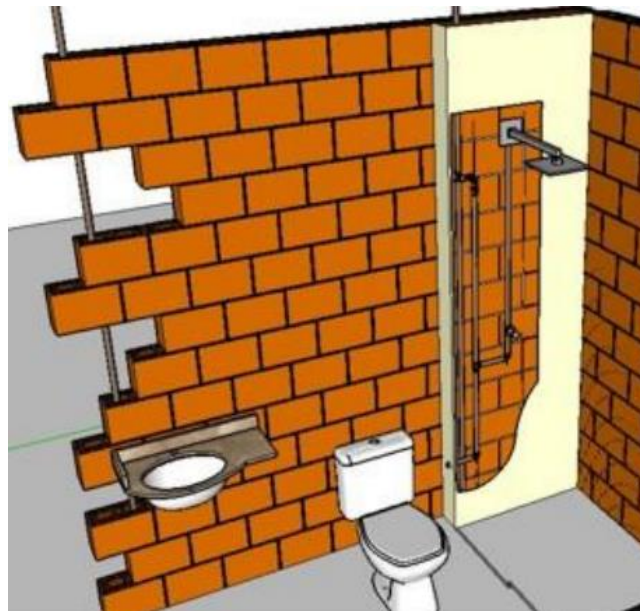
Figura 6 – Apresentação 3D da solução em abertura do tipo shaft e embutida para colunas hidráulicas.
