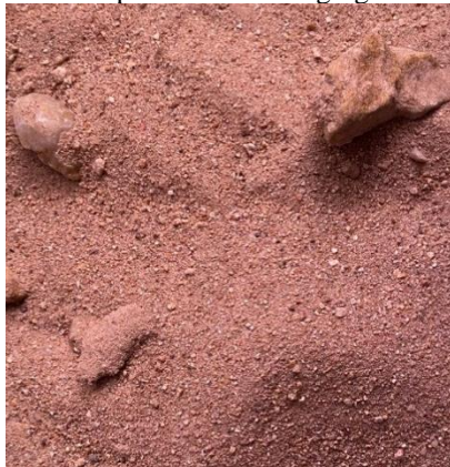
Figura 08 - Aspecto visual do agregado natural.
