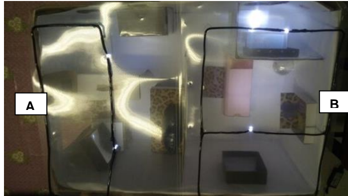
ig.2. Lateral esquerda (A) circuito em série. Lateral direita (B) Circuito em paralelo.
