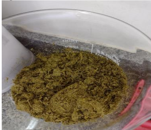
Figura 17 - Resíduos sólidos resultantes da filtração
