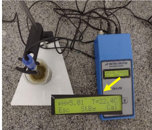
Figura 11 - Leitura de pH no peagômetro
