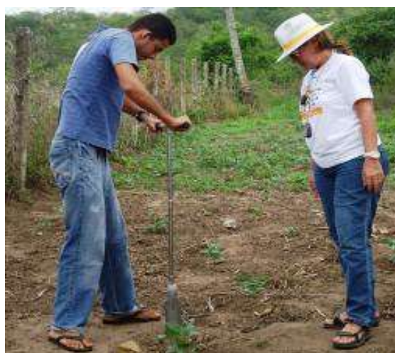
Figura 3. Coleta do solo com o trado de caneco. Microrregião de Guarabira, Paraíba. Fonte: pesquisa de campo, 2012.
