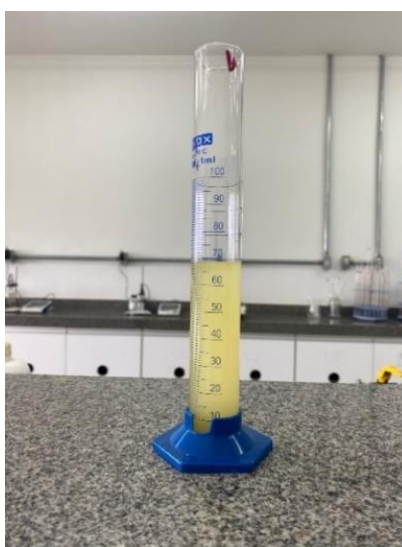
Figura 7 - Conteúdo da reação na proveta de 100 mL para aguardar a separação de fases.
