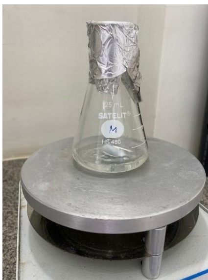
Figura 8 - Produção do catalisador metóxido de potássio.
